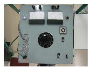
図 1.3: 標準球ギャップによる交流高電圧の測定用装置の操作部
