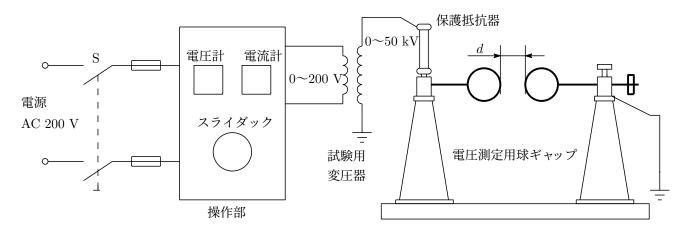
図 1.1: 標準球ギャップによる交流高電圧の測定回路図
