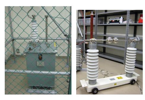
(a) 試験用変圧器の外観
