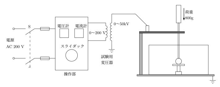
図 2.1: 固体絶縁材料破壊試験の回路図
