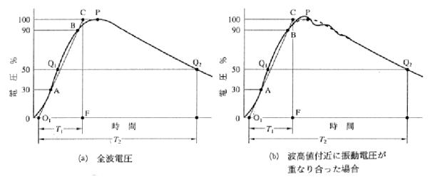
図 3.1: 規約による雷インパルス全波電圧の表示
